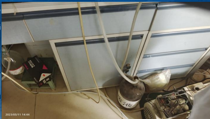
某大学实验室危险废物暂存区域 及容器、包装物无任何标志
