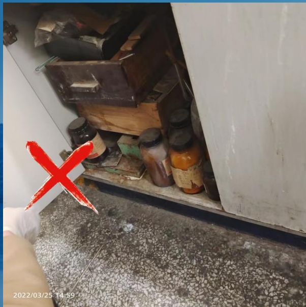
过期废试剂长时间未处理、 周边存在泄露痕迹
