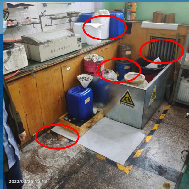
三防措施不到位，紧靠热源存在 安全隐患，地面已造成遗撒
